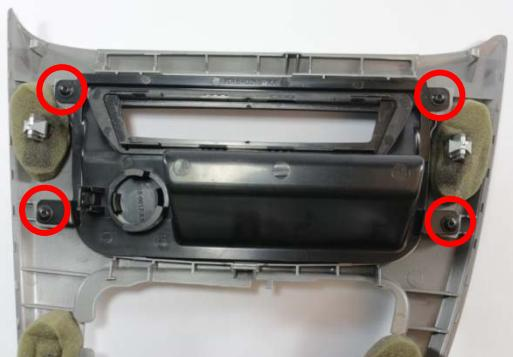
Die 4 Schrauben lösen und das Ablagefach abnehmen.
