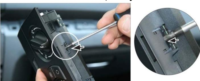
Die Klimabedieneinheit mit einem Schraubenzieher ausklippen und von der Originalabdeckung lösen.
