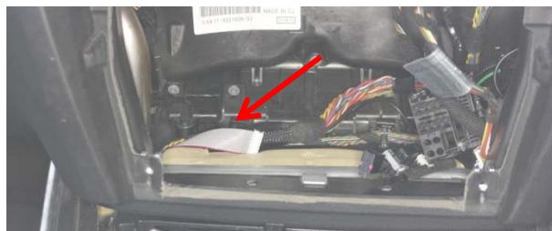
Die Verkleidung der Mittelkonsole wieder montieren und darauf achten, dass das Flachbandkabel im Radioschacht liegt.
