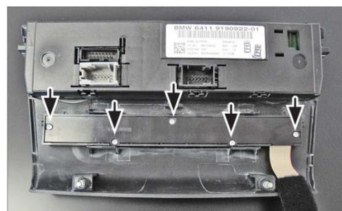
Die 5 Schrauben auf der Rückseite der Schaltleiste entfernen und die Leiterplatte herausnehmen.
