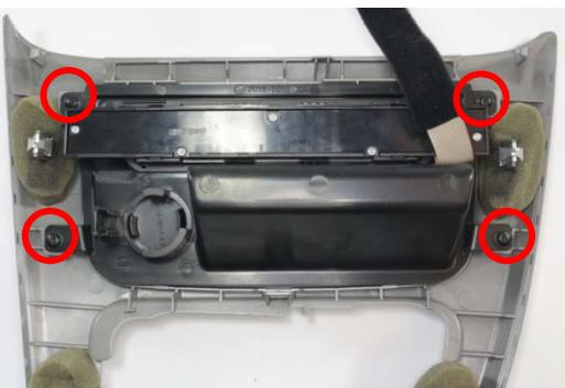
Das neu Ablagefach an der Blende festschrauben und die Schaltleiste einbauen.
