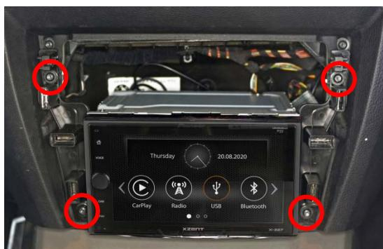
Das Radio mit den 4 Schrauben montieren. Das Klimabedienteil provisorisch einsetzen, um die Spaltmaße zu prüfen.
