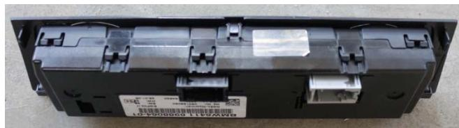
Die Klimabedieneinheit in die neue Blende einsetzen.
