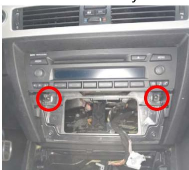
Die 6 Schrauben entfernen und den Radiohalter ausbauen.
