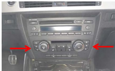
Die 2 Schrauben entfernen und das Radio ausbauen.
