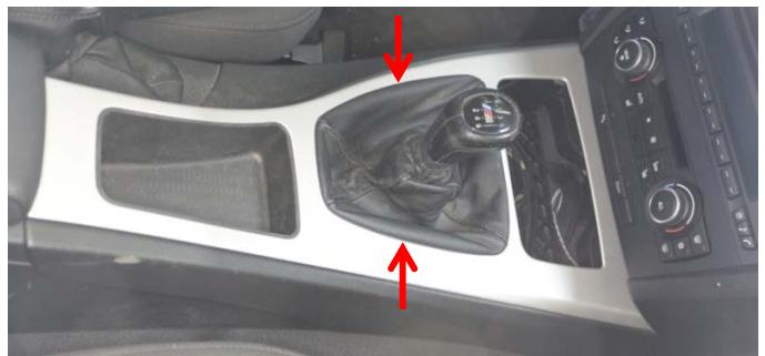
Die Verkleidung der Mittelkonsole ausklipsen.
