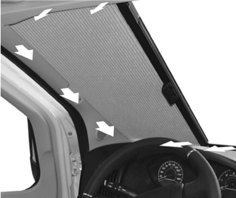
Bei vielen Modellen, kann durch einfaches Entfernen des Türdichtung Gummis und Lösen der Laufschiene des Sonnenrollos genügend Spielraum geschaffen werden, um die A-Säule im unteren Bereich hervorzuziehen.
